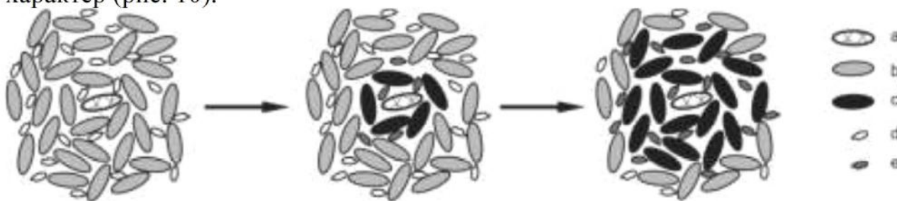
Рисунок 11 – Схема протекания автолокализованного ферментативного гидролиза: а – механически разрушенная клетка, б – исходная клетка, с – гидролизированные клетки, д – частицы нереагирующих ферментов, е – частицы реагирующих ферментов.
