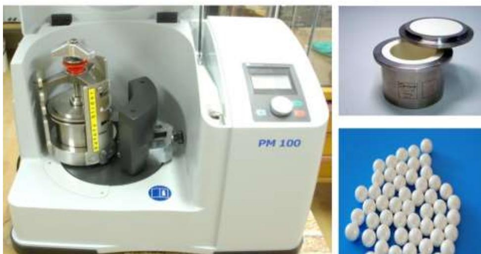
*Рисунок 10. Планетарная мельница Retsch PM 100 и размольная гарнитура (барaban, шары) из стабилизированного  $t\text{-ZrO}_2$ .*
