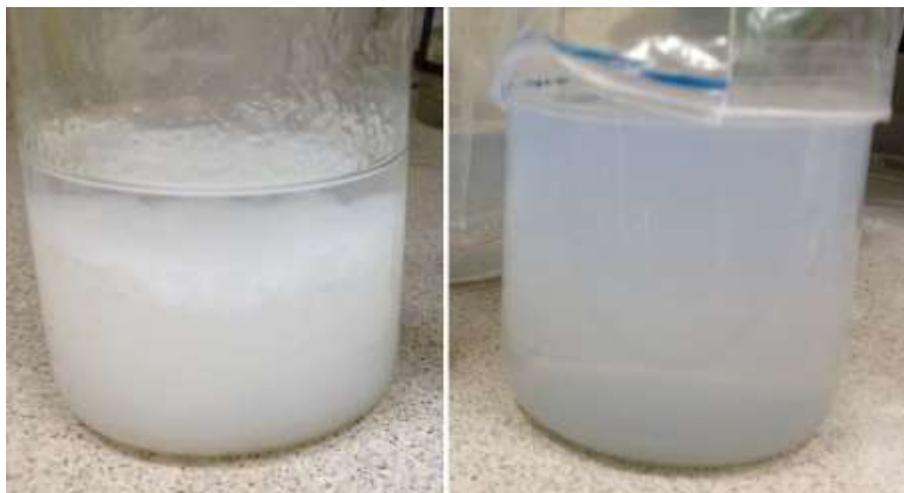
*Рисунок 51. Гидратированные формы оксидов гафния и германия до (слева) и после ультразвукового диспергирования (0,1 М) (справа).*
