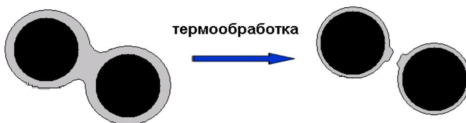
*Рисунок 57. Схема образования наростов на SiC волокнах с покрытием.*
