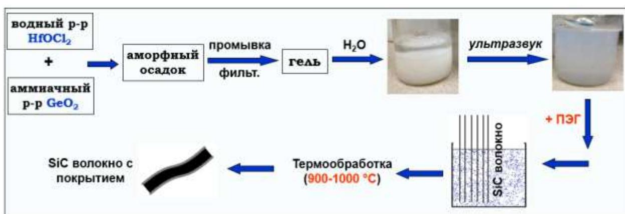
Рисунок 11. Схема нанесения покрытий из золь германатов гафния на SiC волокно.
